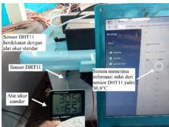
Gambar 13. Kalibrasi Sensor DHT11 Terhadap *Digital Temperaturemeter*
