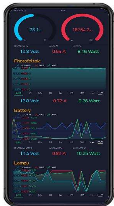
Gambar 9. Monitoring Display PJU-TS pada Smartphone
