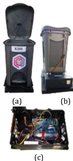
Gambar 4.1 Perangkat Keras (a)Tampak Depan (b)Tampak Belakang (c)Box Sensor
