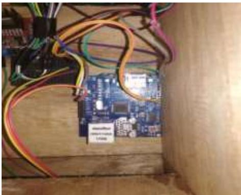
Gambar 6. Perangkat Proses Modul Arduinodan Ethernet Shield
