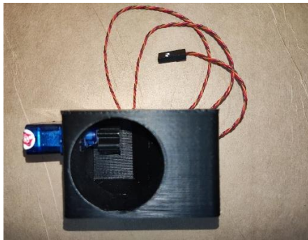
Gambar 8. Pemasangan Servo ke Bracket
