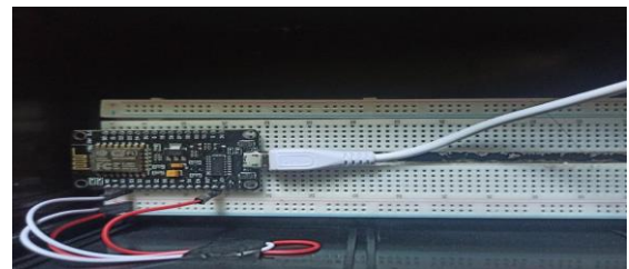
Gambar 8. Pemasangan NodeMCU dengan Breadboard
