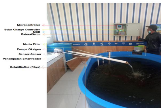
Gambar 6. Rangkaian Sistem Monitoring dan Kontrol Bioflok
