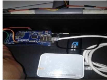
Gambar 3.3 Penyambungan modem dan router ke ethernet shield
