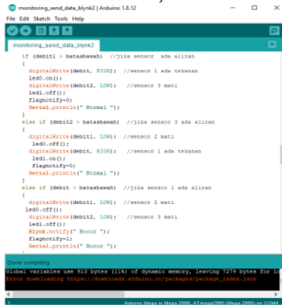
Gambar 3.6 Program membaca kondisi kebocoran
