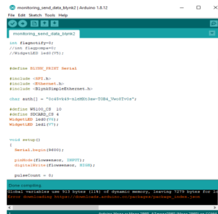
Gambar 3.4 Program untuk menghubungkan mikrokontrol dengan aplikasi blynk
