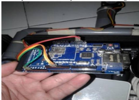
Gambar 3.2 Pemasangan pin-pin dari sensor ke Arduino mega
