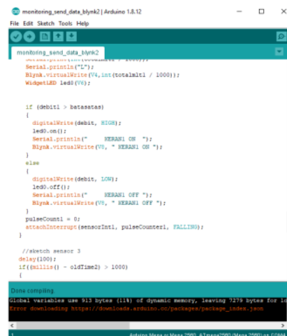
Gambar 3.7 Program untuk membaca kondisi ON dan OFF pada keran
