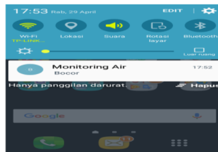
Gambar 3.11 Notifikasi saat terjadinya kebocoran
