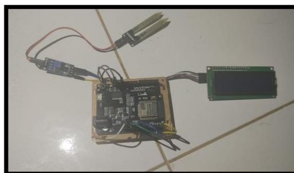
Gambar 10. Pemasangan sensor YL-69 ke WEMOS
