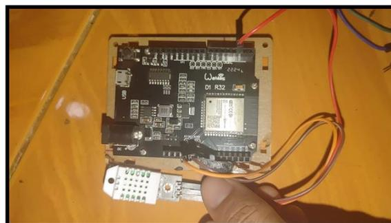
Gambar 12. Pemasangan DHT-22 ke WEMOS
