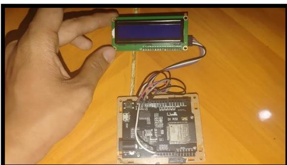
Gambar 8. Pemasangan LCD ke WEMOS
