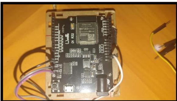
Gambar 7. Pemasangan Kabel LCD ke WEMOS
