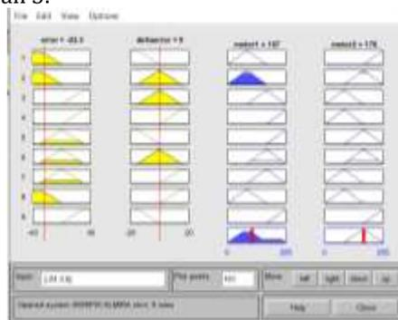
Gambar 12 Rule ketika nilai error negative dan delta error zero
