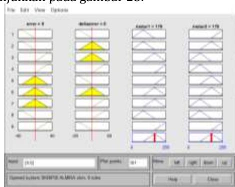
**Gambar 20** Rule ketika nilai error zero dan delta error zero
