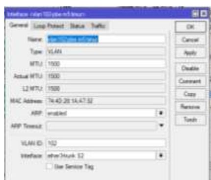
Gambar 11. Konfigurasi Sub-Interface VLAN 102
