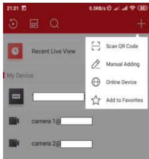
Gambar 10. Cara penambahan perangkat CCTV Pada gambar 10 menunjukkan penambahan Device atau perangkat CCTV dengan 3 cara yaitu scan QR code, manual adding dan onlineDevice .
