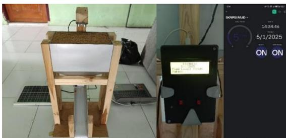
Gambar 8. Hasil Pengujian Ultrasonic Pada Kondisi Pakan Penuh
