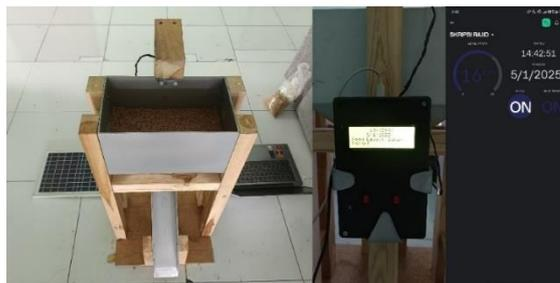
Gambar 9. Hasil Pengujian Ultrasonic Pada Kondisi Pakan Setengah
